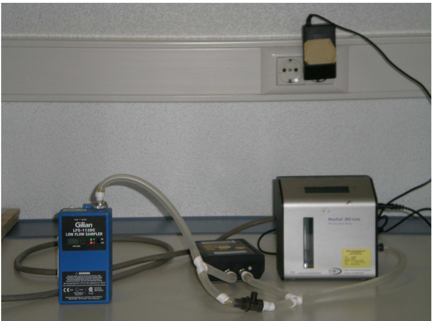
Los tubos deben sumar una longitud total, igual o inferior a 80 cm. Es necesario sellar con cinta de teflón todas las uniones entre elementos para asegurar que la pérdida de carga no varía por entradas o fugas de aire.
