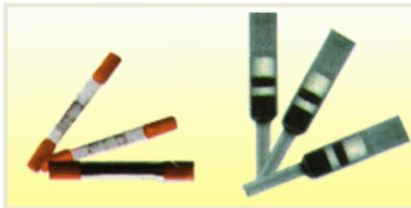
**Figura 1** .Tubos adsorbentes de distinto material de relleno para el muestreo de todo tipo de gases y vapores orgánicos.
