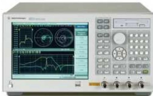
Figura 3.18: Analizador de redes vectorial E5070B de Agilent.
