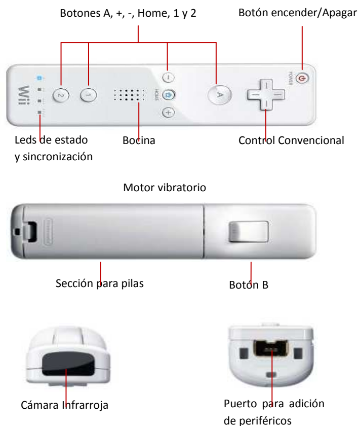
Figura 2.14. Elementos del controlador WiiMote .
