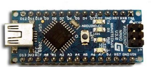
**Figura 4.6:** Arduino Nano v3.
