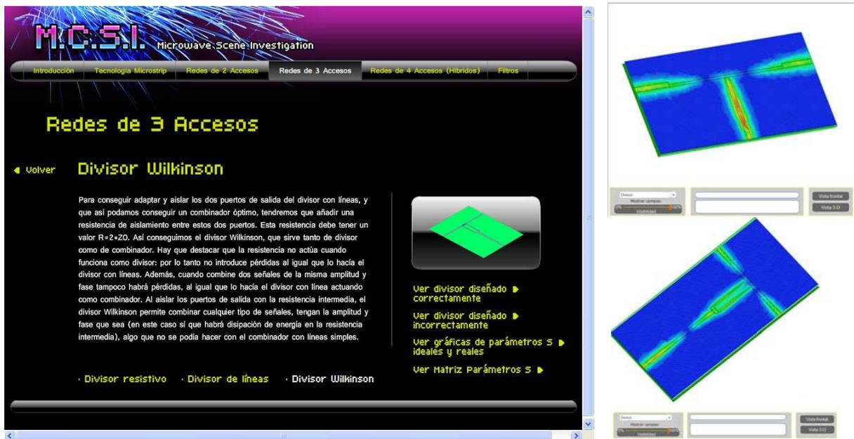
Figura 7: Ventanas mostrando diferentes circuitos divisores/combinadores de microondas.
