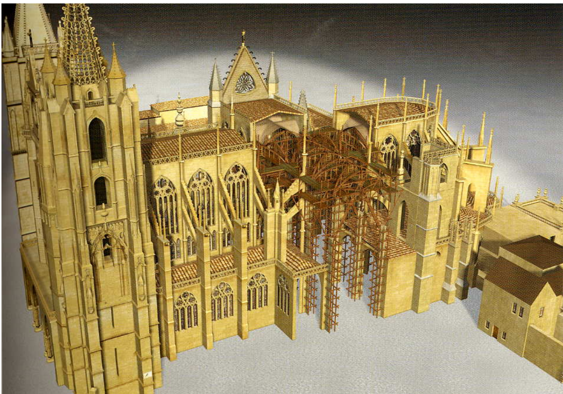
Figura 20: Maqueta infográfica con la representación virtual de la catedral de León con el desmonte del brazo sur del crucero y la aplicación del sistema de encimbrados y entibaciones para su reconstrucción.
