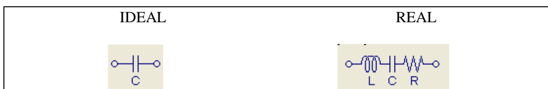
Fig. 5.15- Circuito equivalente de un condensador real
