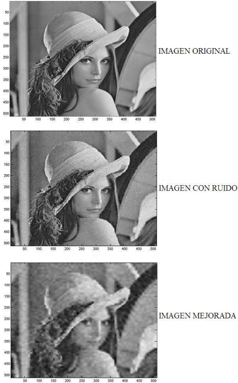
Figura 12: Prueba realizada con la imagen de Lena con 3 niveles de resolución y 10 de varianza de ruido aplicando el método PPH: imagen original, imagen con ruido e imagen mejorada
