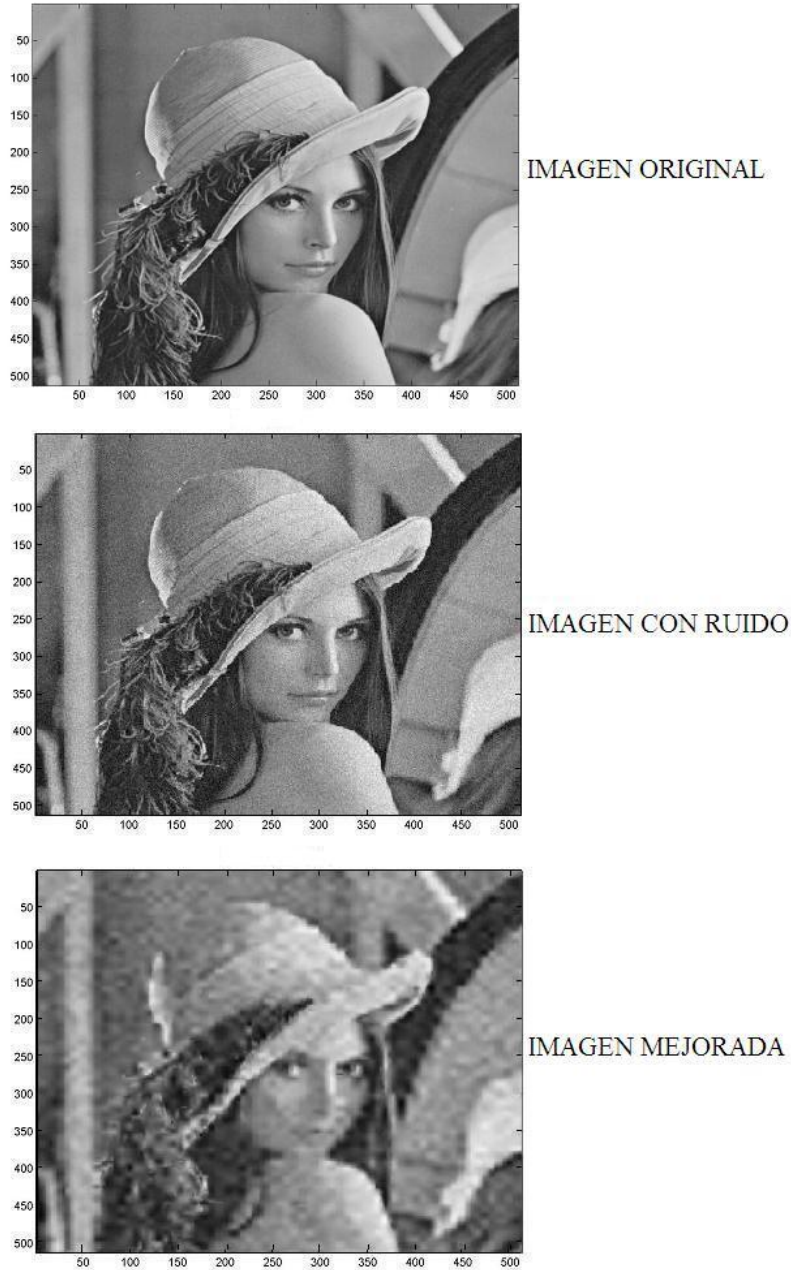
Figura 9: Prueba realizada con la imagen de Lena con 3 niveles de resolución y 10 de varianza de ruido aplicando el método lineal: imagen original, imagen con ruido e imagen mejorada
