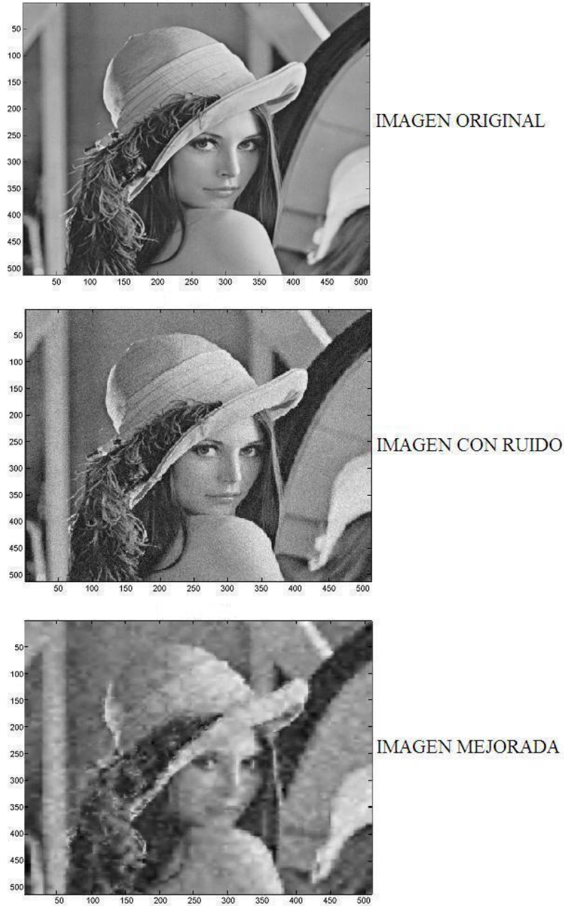
Figura 10: Prueba realizada con la imagen de Lena con 3 niveles de resolución y 10 de varianza de ruido aplicando el método ENO: imagen original, imagen con ruido e imagen mejorada
