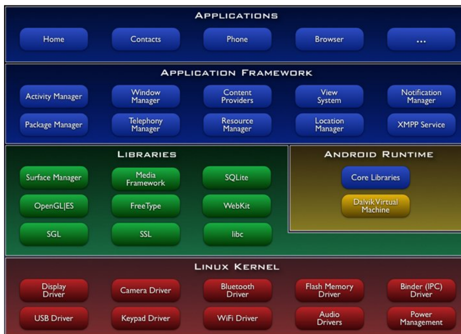
Figura 2. Las diferentes capas que conforman el sistema operativo Android.
