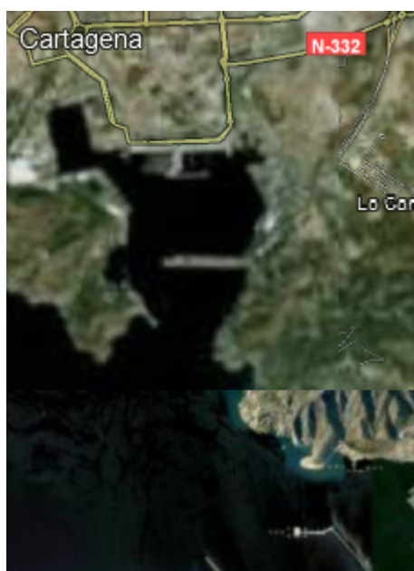
Figura 2. Detalle de un mapa de Google Maps en mitad de un aumento de zoom. Se puede ver con claridad el mosaico formado por la pieza inferior, que ya ha cargado la imagen a la resolución solicitada, y la pieza superior, que mantiene una versión ampliada de la imagen antigua.
