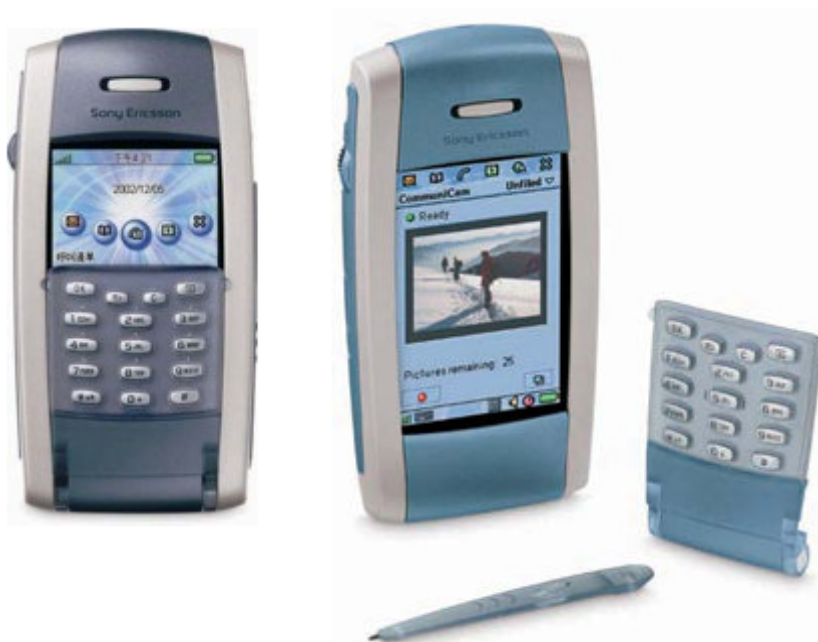
Figura 8. Teléfono móvil Sony Ericsson P800 (finales de 2002), con teclado desmontable y pantalla táctil.
