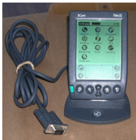
Figura 2. Dispositivo PDA, modelo Palm III de 1999, desarrollado por Palm Computing. Pantalla táctil LCD con 4 tonos de gris, 8 MB de memoria RAM. La imagen muestra el dispositivo acoplado a su base de conexión al PC.
