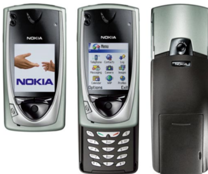
Figura 7. Teléfono móvil Nokia 7650 (2002). Con Symbian OS 6.1 y 3,6 MB de espacio adicional, permitían instalar aplicaciones como por ejemplo una versión del navegador Opera.
