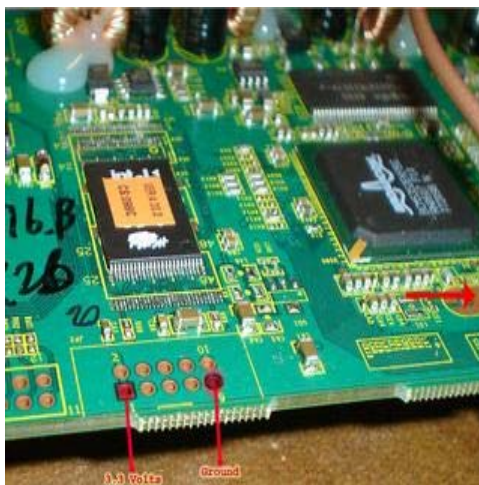
Figura 5. Alimentación y masa en la parte superior de la placa.
