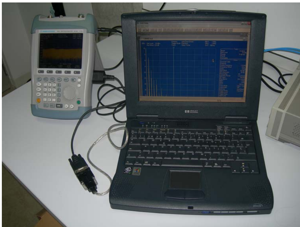
Figura 4.17. Conexión del FSH-3 con el ordenador para la extracción de medidas
