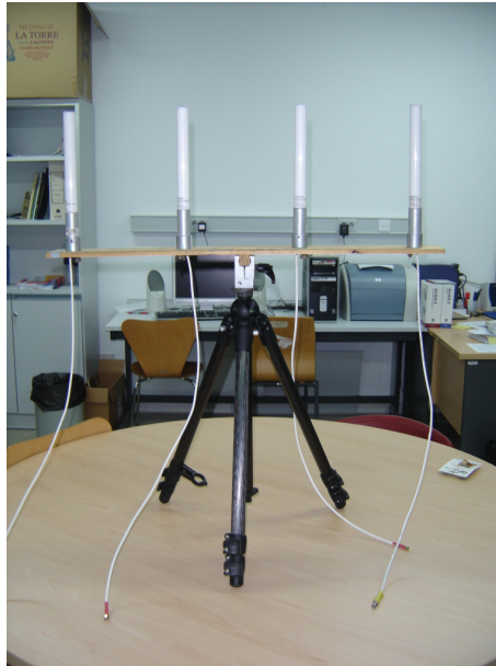
Figura 30: Array de 4 antenas en trípode
