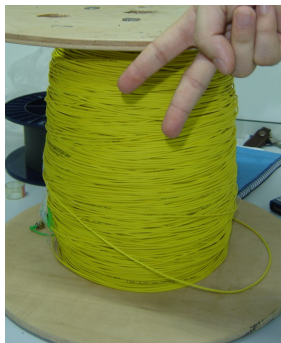
Figura 20: Bobina de 50 Metros de fibra óptica monomodo.
