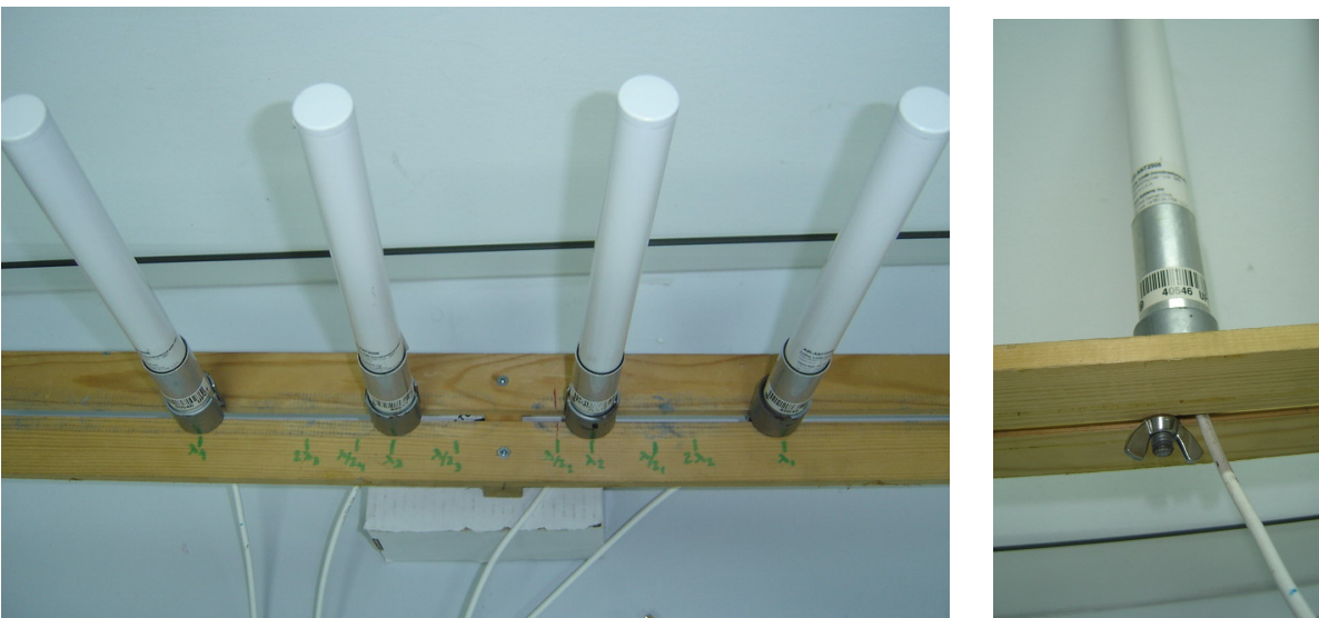
Figura 29: Array de 4 antenas sobre la guía ranurada configuradas en \lambda .
