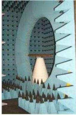
Fig. 2.4 – Arco de la cámara de campo próximo
