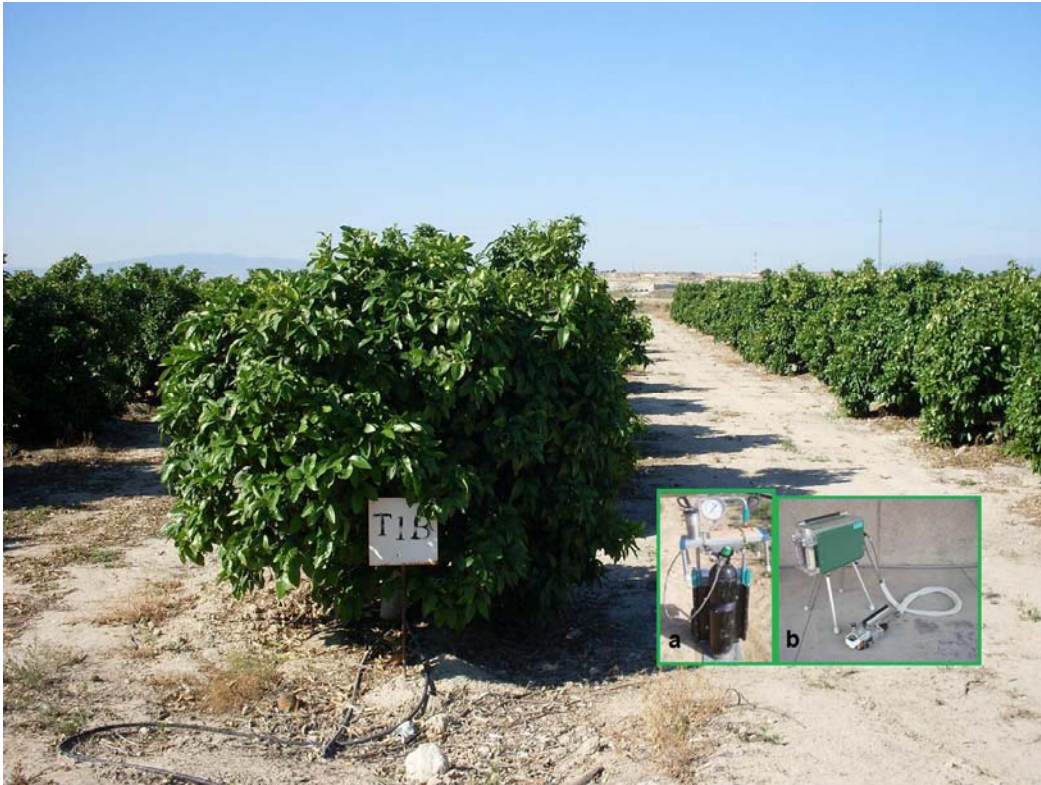
Figura 10: a) Equipo de medida del potencial de tallo se utilizando una cámara de presión (modelo 3000, Soil Moisture Equipment Corp., Santa Barbara, California, EEUU) y b) Equipo de fotosíntesis portátil (Li-6400, Li-Cor, Lincoln, NE, EEUU).
