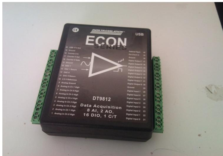
Fig.-3.1.-Tarjeta de adquisición "DT9812" de la casa "Data Translation".
