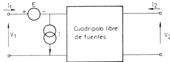
**Figura 2.3-29** Descomposición de un cuadripolo con fuentes internas en dos generadores y un cuadripolo libre de fuentes.
