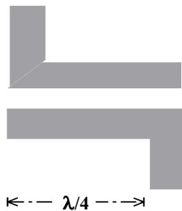
Figura 3.3-8 Inversor con líneas acopladas de  $\lambda/4$
