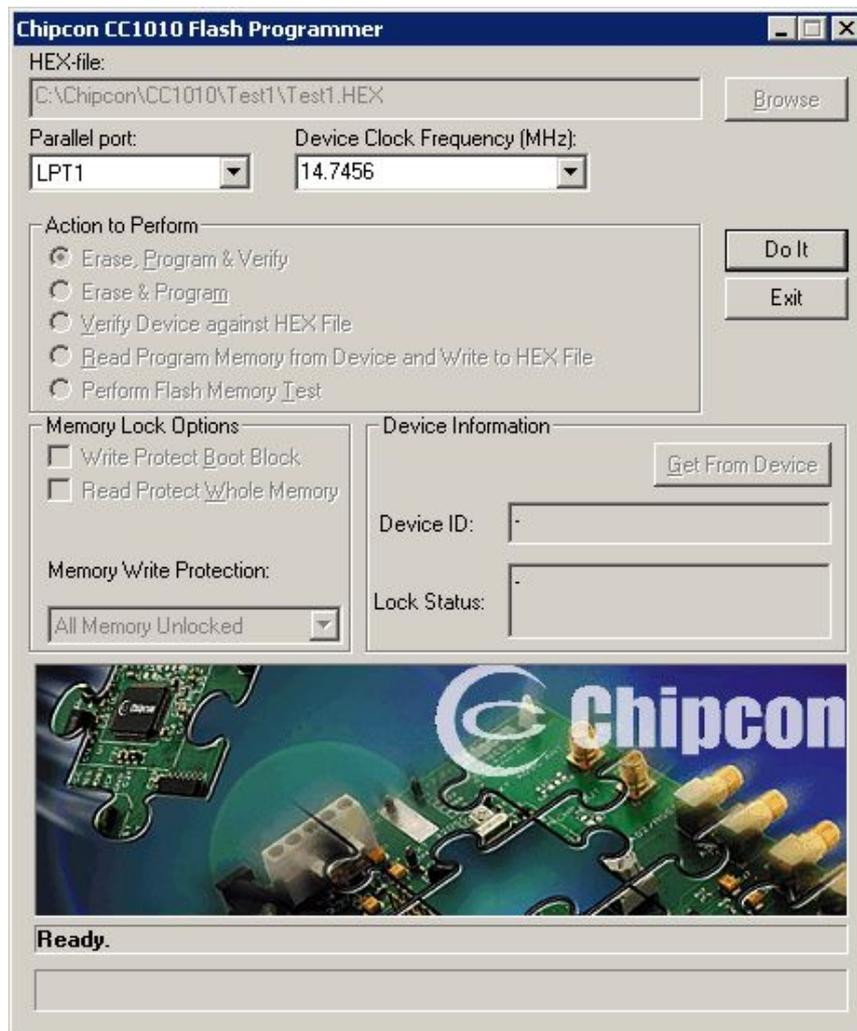
Figura 18: Software de programación del CC1010.
