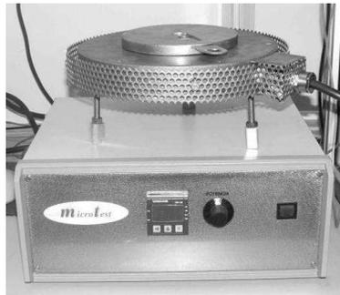
**Figura 29. Horno del tribómetro.**
