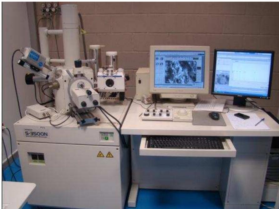
**Figura 38. Microscopio electrónico de barrido Hitachi S-3500N.**
