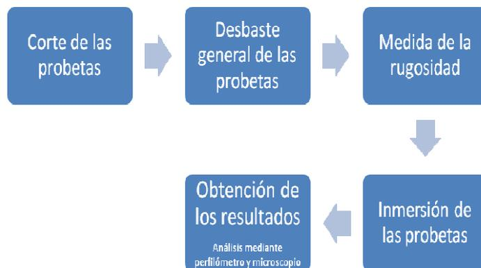
**Figura 57. Procedimiento experimental seguido en los ensayos de inmersión [106].**
