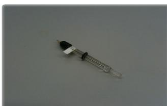
**Figura 46. Electrodo de referencia AgCl 3,5 M.**
