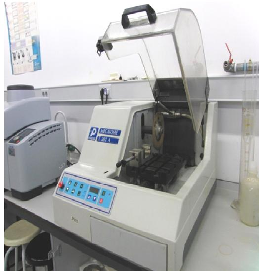
**Figura 33. Cortadora de precisión.**
