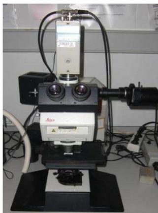
**Figura 37. Microscopio óptico Leica DMR.**
