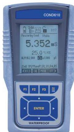
**Figura 43. Medidor de conductividad.**
