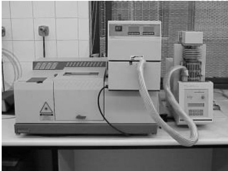
**Figura 40. Espectrómetro infrarrojo.**
