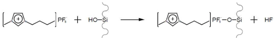
**Figura 22. Modelo propuesto para la adhesión [BMIM]PF<sub>6</sub> a la silicona [102]**
