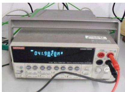
**Figura 32. Medidor de resistencia eléctrica conectado al tribómetro.**
