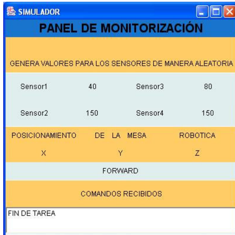
Figura 20. Visualización de los valores de sensores generados y de los comandos de posicionamiento recibidos
