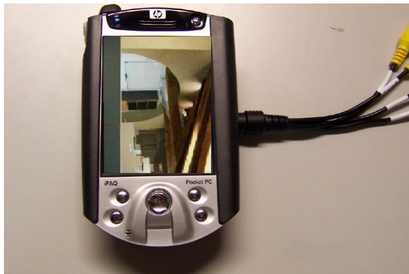
Figura 6. iPAQ Pocket PC capturando vídeo en tiempo real a pantalla completa
