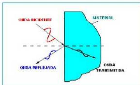
**Figura 2.19. Comportamiento de una onda que incide sobre un material [11]**
