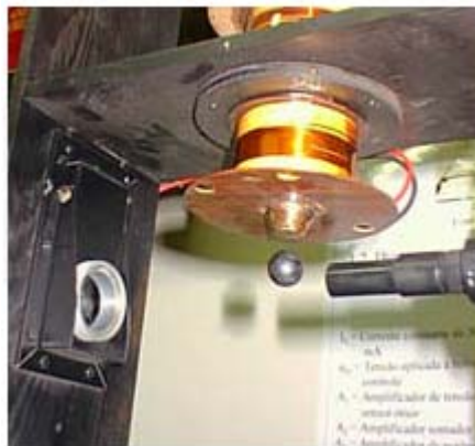
Figura 2.16: Funcionamiento del levitador magnético diseñado y construido en el Departamento de Física de la Universidad de Murcia.
