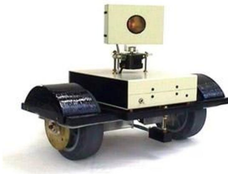
Figura 4.1 Configuración diferencial
