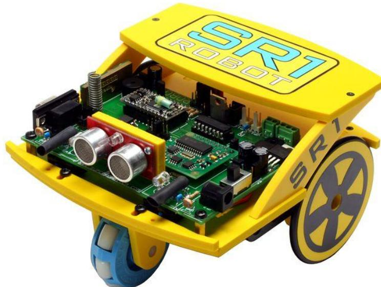
Figura 4.3 Configuración de triciclo
