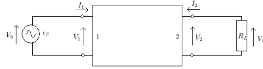
Figura 3.7: Red dos puertos de terminación resistiva única
