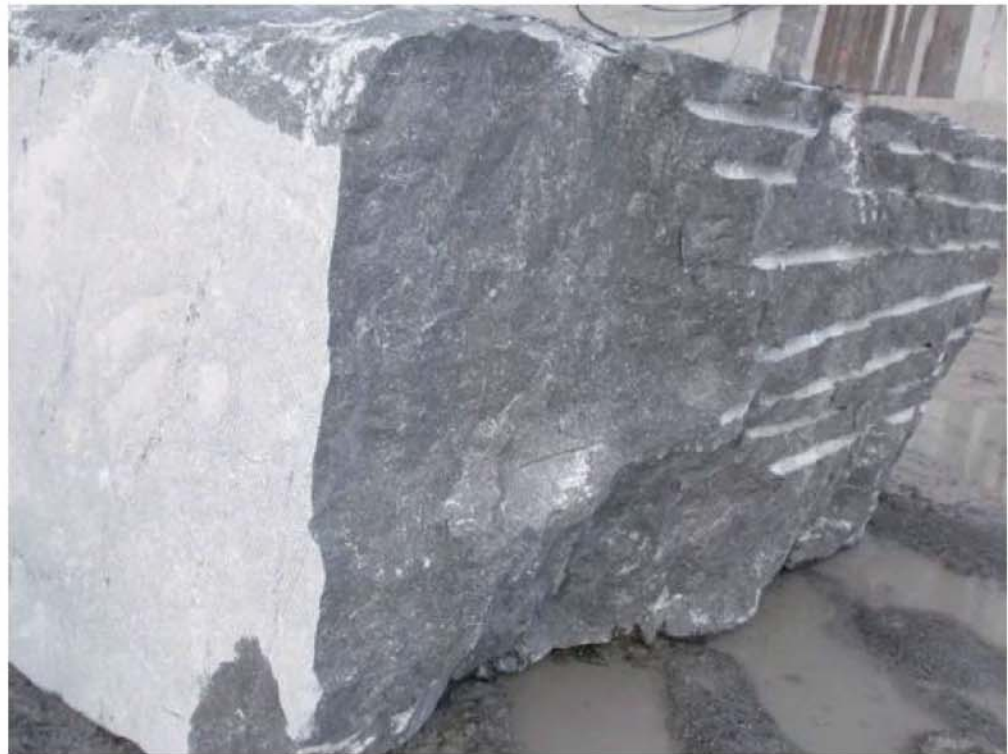
Cara lateral de bloque con mucho desperdicio por una propagación anómala de fractura
