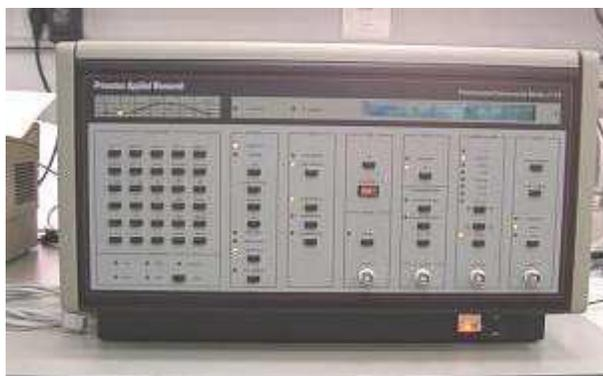
Figura 3.2. Potenciostato PAR 273
