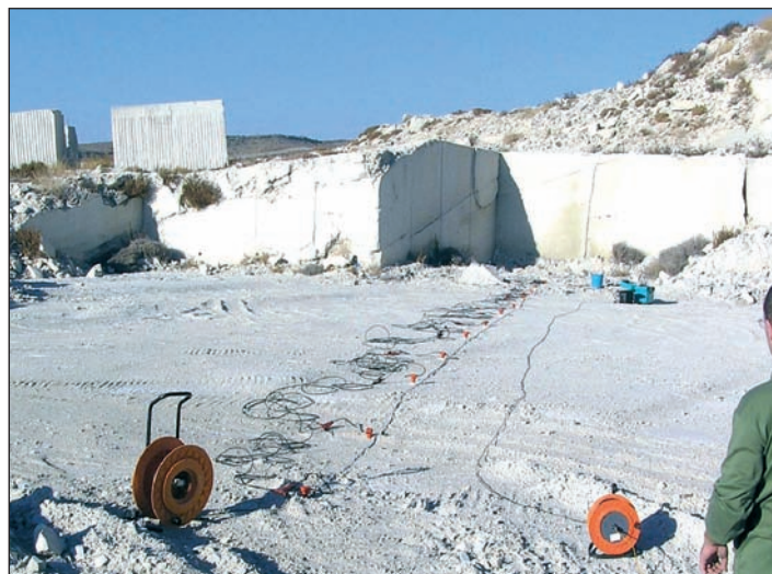
[Foto 3].- Trabajos de sísmica, línea de sísmica de refracción (Grupo GEOMEX).
