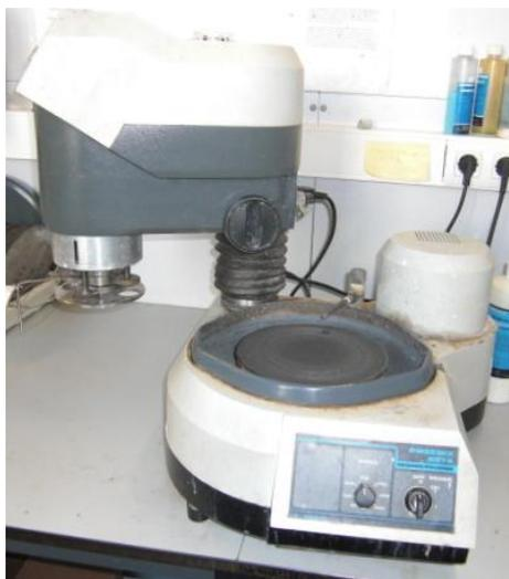
*Figura II.13. Pulidora metalográfica.*
