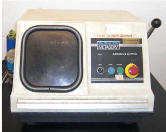
*Figura II.12. Cortadora de precisión.*
