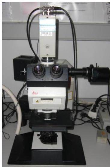
*Figura II.16. Microscopio óptico Leica DMR.*
