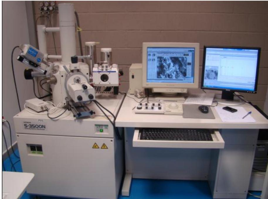
*Figura II.17. Microscopio electrónico de barrido.*
