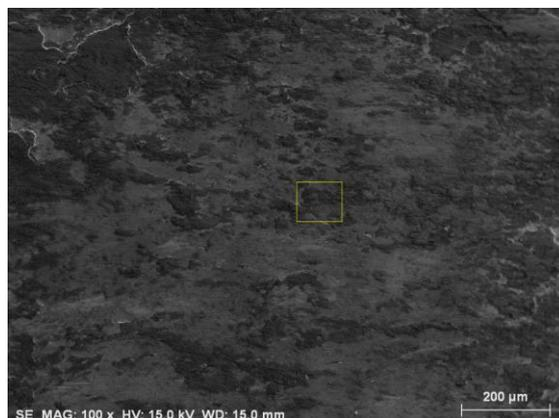
Figura III.27. Micrografía SEM en la bola de acero en contacto con Al 7075 en seco
