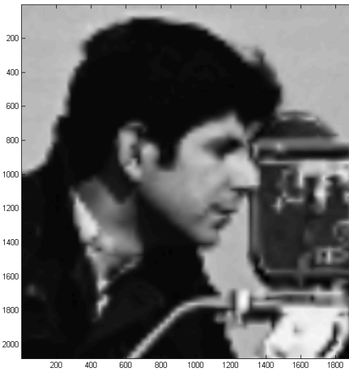
Figura 4.25: Zoom de 'camera2.pgm' en la zona [x_1 = 90, x_2 = 150, y_1 = 35, y_2 = 100] aplicando el método WENO con 5 niveles.
