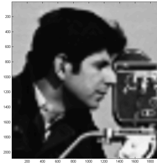
Figura 4.26: Zoom de 'camera2.pgm' en la zona [x_1 = 90, x_2 = 150, y_1 = 35, y_2 = 100] aplicando el método PPH con 5 niveles.
