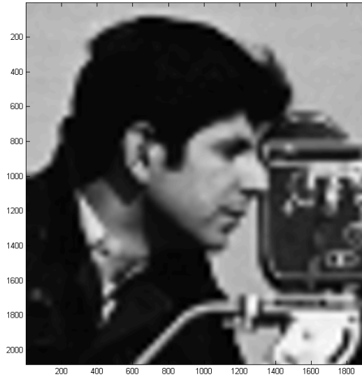
Figura 4.22: Zoom de 'camera2.pgm' en la zona [x_1 = 90, x_2 = 150, y_1 = 35, y_2 = 100] aplicando el método Lineal con 5 niveles.
