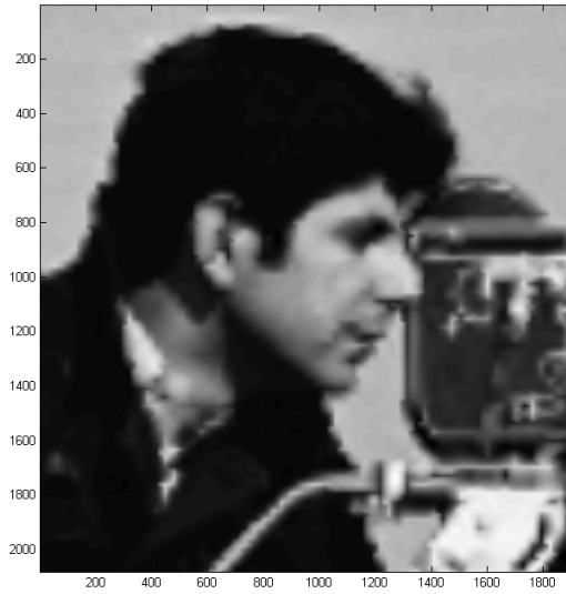
Figura 4.24: Zoom de 'camera2.pgm' en la zona [x_1 = 90, x_2 = 150, y_1 = 35, y_2 = 100] aplicando el método ENO no jerárquico con 5 niveles.
