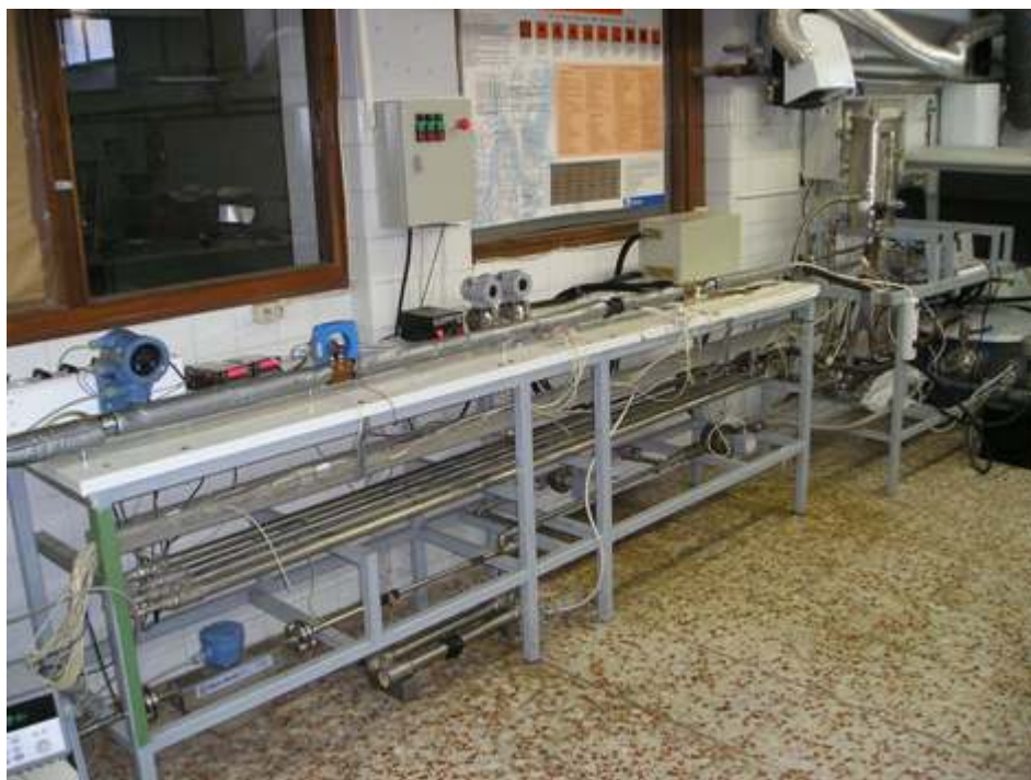
Figura 2.15 Fotografía de la instalación experimental para los ensayos térmicos. Vista general de la sección de medida.
