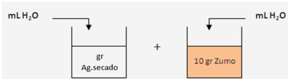
Figura 23: Esquema de preparación de las muestras para el proceso de secado.
