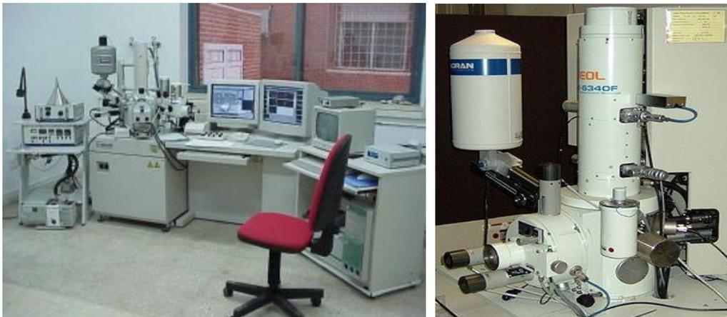
Figura 45: Microscopio de barrido, Hitachi modelo S-3500 N.
