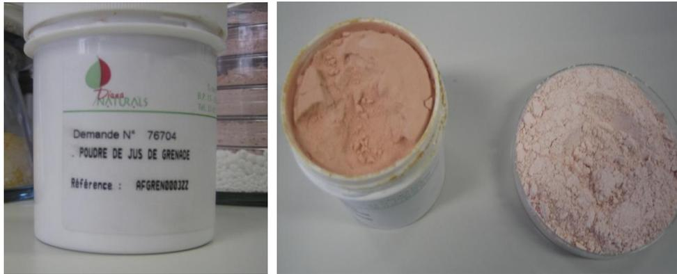
Figura 51: En la figura se puede observar la diferencia entre los microencapsulados de zumo de granada comercial y los obtenidos en el laboratorio.
