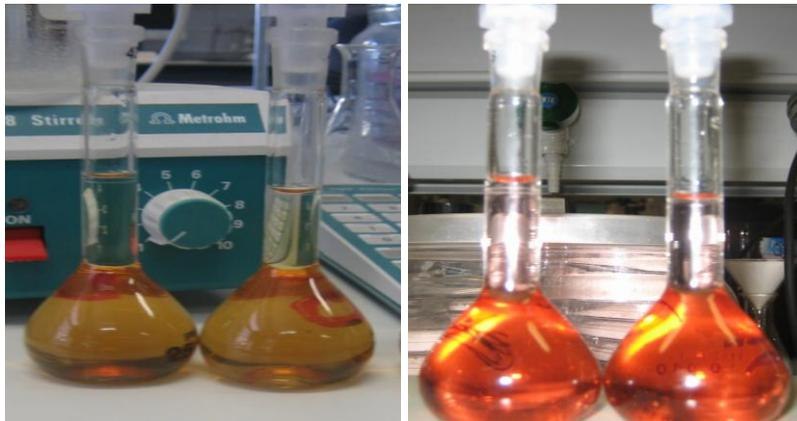
*Figura 36: Disoluciones de los microencapsulados en Buffer pH 1.0 y pH 4.5.*
