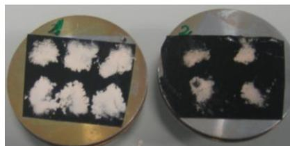
*Figura 65: Preparación de muestras para SEM. De izquierda a derecha, muestra de maltodextrina y nutritosa.*
