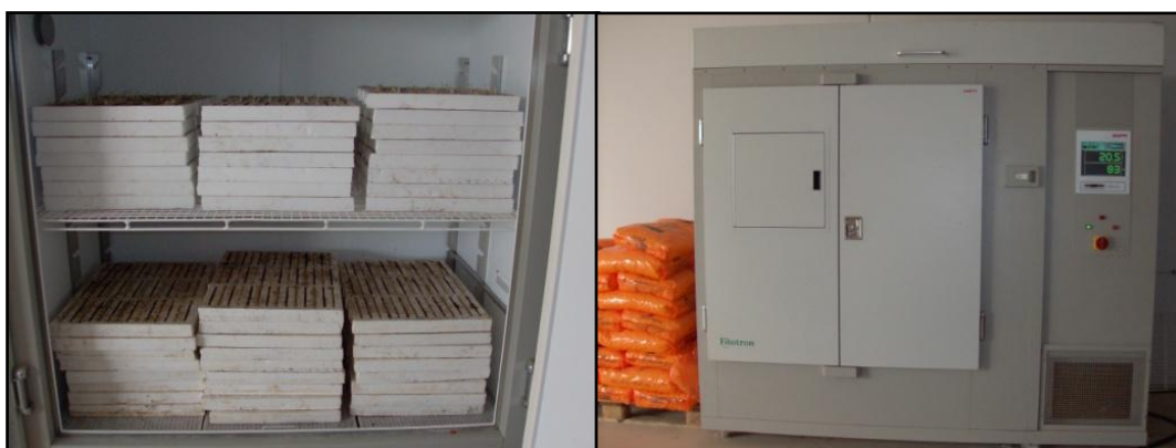
Figura 12: Bandejas en el interior de la cámara climática y exterior cámara climática.
