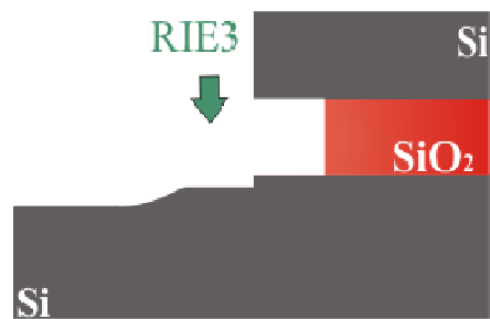
Fig. 3.6 Tercer paso de RIE. El esquema muestra el resultado en la geometría de los dispositivos después de aplicar un tercer paso de RIE. Obteniendo en este caso y una geometría más simétrica.
