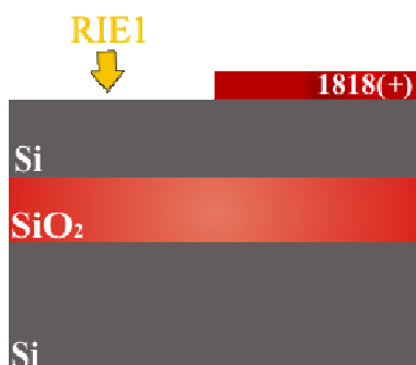
Fig. 3.2 Primer paso de RIE. El esquema muestra la zona de aplicación del RIE1 así como la capa de fotorresistor 1818 positivo sobre la primera capa de silicio
