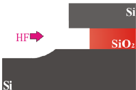
Fig. 3.5 Erosión selectiva del nanogap. En este esquema se muestra la formación de la zanja creada con un etching húmedo, en este caso realizado con HF en la capa de \text{SiO}_2 .
