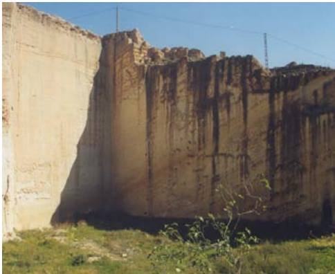
Foto 8. Estratos buzando unos 22^\circ hacia el norte. El contorno poligonal de la cantera permite apreciar bien la diferencia entre buzamiento real y aparente. Foto9. Ejemplo de talud a contrapendiente por seguir un plano de diaclasa.
