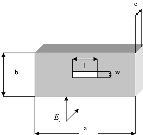
Fig. 1. Cavity a cm. x b cm. x c cm. con ranura l cm. x w cm.
