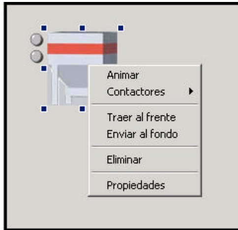
Figura 92.-Menú desplegable que aparece al pulsar el botón derecho del ratón sobre un elemento con Led de contactor, como es el caso de la tolva.
