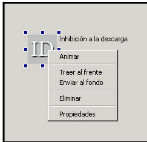
Figura 103.-Menú desplegable que aparece al pulsar el botón derecho del ratón sobre el elemento Inhibición a al descarga.
