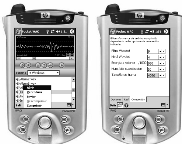
Figura 3. Aplicación para PocketPC que permite capturar, visualizar, comprimir y enviar vía WiFi señales FCG
