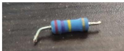
Imagen 53. Resistencia de descarga de condensadores tipo X.
