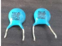
*Imagen 55. Condensadores Y del filtro comercial.*
