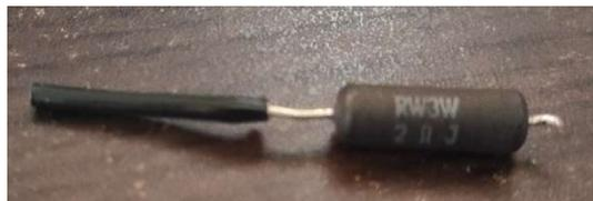
Imagen 51. Resistencia de alambre bobinado.
