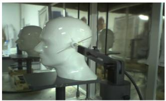
Fig. 3. Fotografía del sep-up de medida de la presencia del usuario en RC.
