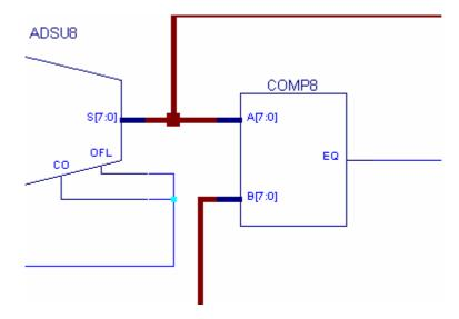
Como se puede observar, este módulo cuenta con dos entradas, la entrada A a la que le llegará el número total de los coches de dicha planta, procedente del restador y luego la entrada B, a la que le entrará el número treinta (necesario para la comparación ) procedente de un módulo que describiré posteriormente.
