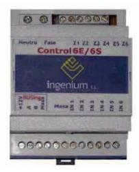
El CONTROL6E6S es un actuador provisto de 6 salidas a relé referidas a la Fase de alimentación del equipo y 6 entradas de baja tensión referidas a la masa del BUS.
