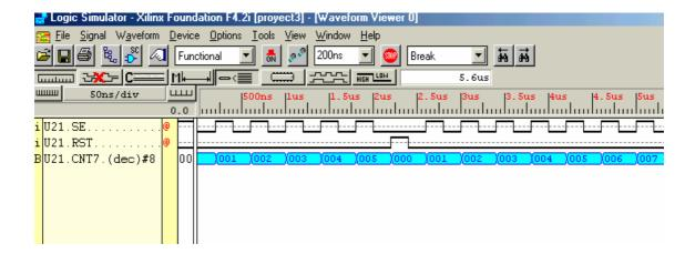
Podemos observar que su funcionamiento es correcto: cada vez que se recibe un pulso en la entrada SE por la entrada o salida del vehículo (dependiendo de si el modulo es de salida o entrada) la salida CNT se incrementa en una unidad, asimismo si activamos la entrada de reset la salida CNT se inicializa y una vez que rst vuelva a 'o' el módulo seguirá con su cuenta.
