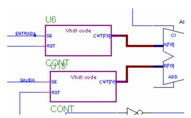
Ambos módulos son iguales, basados en lenguaje VHDL y nos permiten el contaje de los vehículos que entran y salen de la planta , el superior para la entrada de vehículos y el inferior para la salida.
