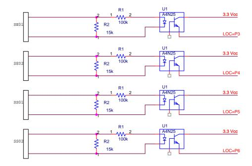
El objetivo de las resistencias R1 y R2 es el de divisor de intensidad, ya que la intensidad óptima de funcionamiento del 4N25 es de 10 ma y la máxima de 30 ma, y la que proporciona cada sensor es de 100 ma. Con este divisor la intensidad de entrada al optoacoplador será de 13 ma aproximadamente.
