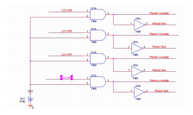
Dado que los 3.3v pueden se considerados son considerados como un 1 lógico, si a cada salida le realizamos una operación AND con 5Vdc, a la salida de cada puerta AND tendremos los 5v necesarios para excitar las entradas del módulo citado anteriormente.
