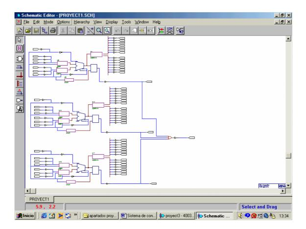
Como se puede observar el esquemático se puede dividir en tres circuitos iguales, una para el control de cada planta, cuyas salidas (para cada planta) se unen al final en una puerta and para el control del parking completo.
