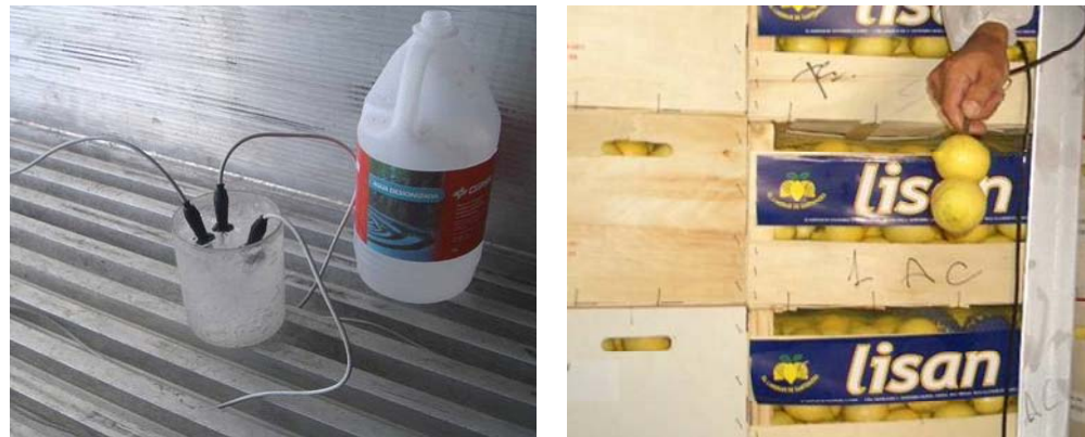
Figura 1-6. Izquierda: calibrado de las sondas con hielo preparado con agua destilada. Derecha: introducción de la sonda en la carga para el registro de temperatura.
