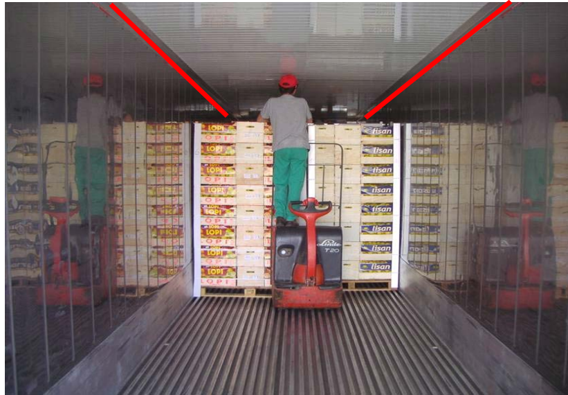
Figura 1-5. Línea roja indicando la altura máxima de estiba en un contenedor refrigerado.
