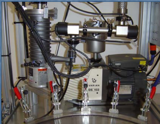
Bombas de vacío
