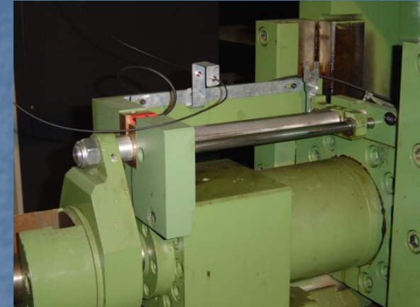
Encoder lineal Resolución 0,1 mm
