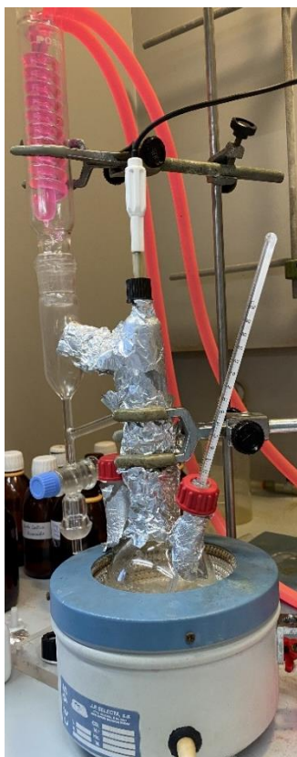
Figura 1. Equipo utilizado para la determinación de datos de equilibrio L-V.
