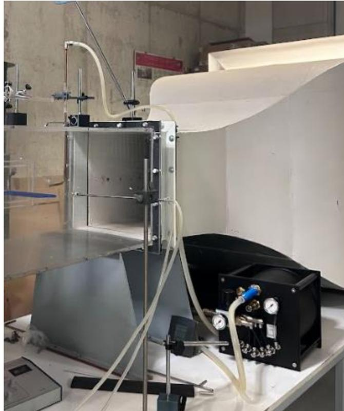
Figura 52. Máquina PivPart30 en la instalación.
