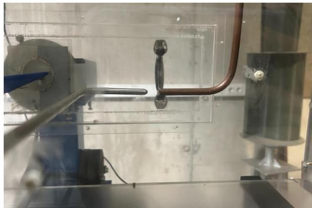
Posición del Pitot máquina de humo en condición 2, 3 y 4 visto desde el lado.
