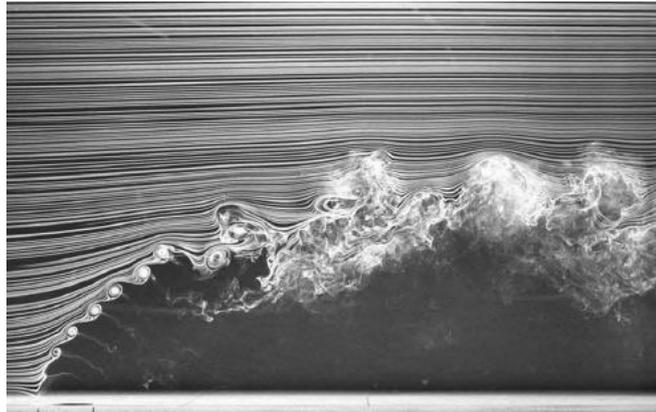
Figura 1. Patrón de líneas de un chorro a través de un flujo usando humo (Fric & Roshko, 1994)
