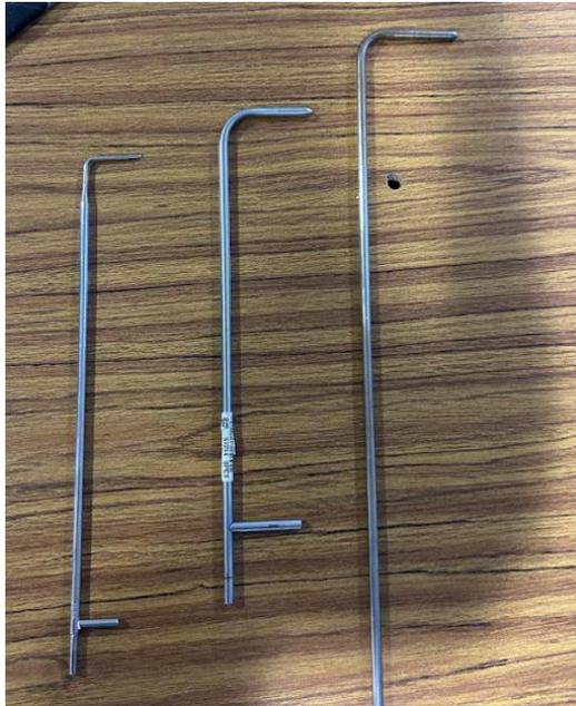
Figura 36. Tubos de Pitot de diferente tamaño del laboratorio.
