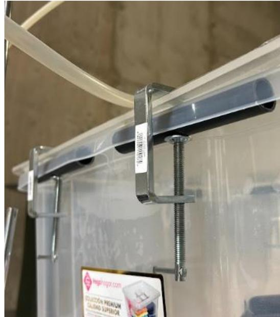
Figura 58. Sargentos colocados en los bordes de la caja transparente.
