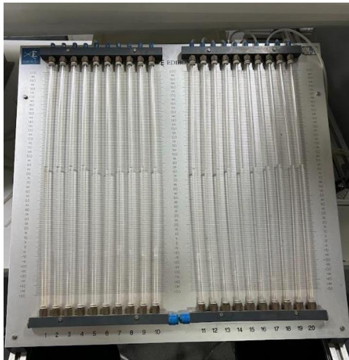
Figura 35. Manómetro inclinado del laboratorio.
