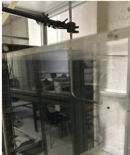
Pitot túnel de viento que se usa de referencia.
