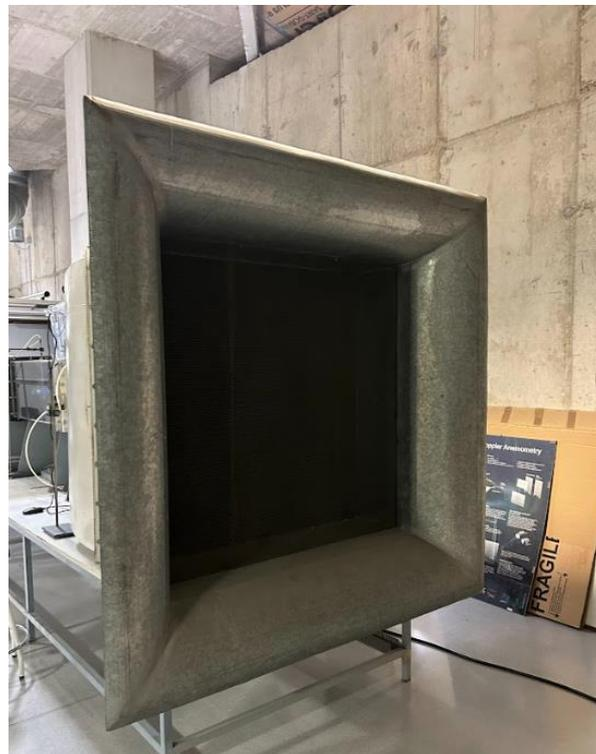
Figura 30. Campana de entrada del túnel de viento.
