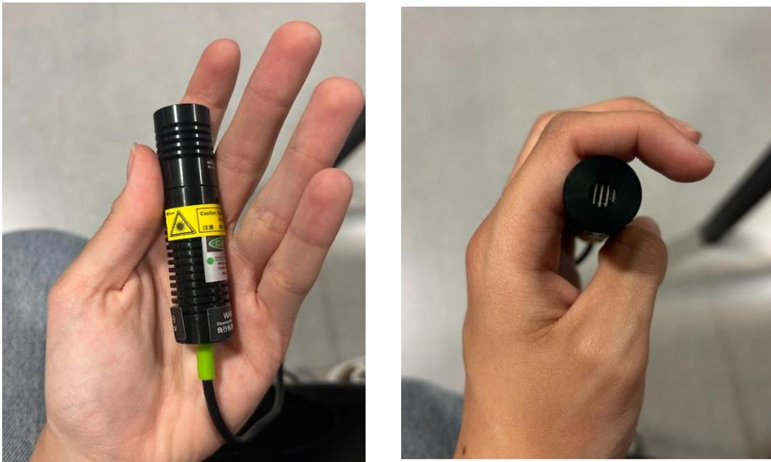
Figura 21. Láser diodo utilizado como sistema de iluminación
