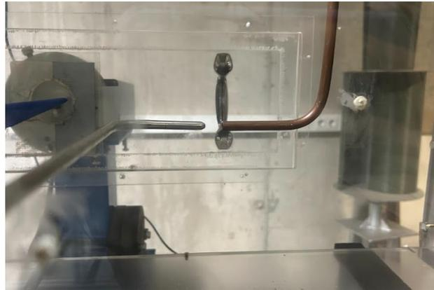
Figura 45. Posición del Pitot máquina de humo en condición 2, 3 y 4 visto desde el lado.
