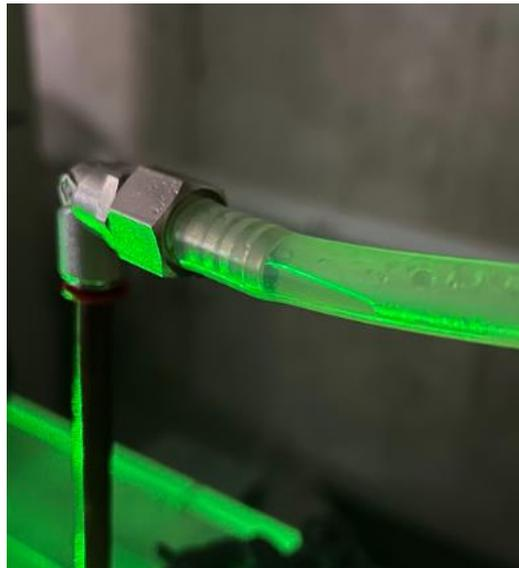
Figura 54. Líquido acumulado en la entrada del codo.
