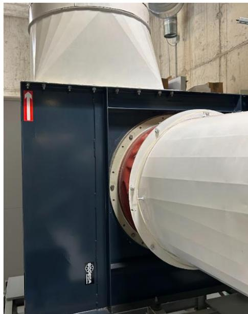
Figura 34. Ventilador del Túnel de Viento.
