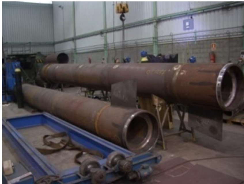
Ilustración 2-17.-Tubos de bocina. Fuente: Newtesol
