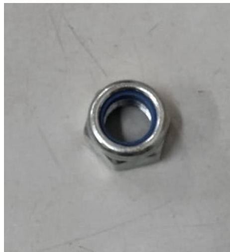
Ilustración 4-20.-Tuerca autoblocante. Fuente: Propia
