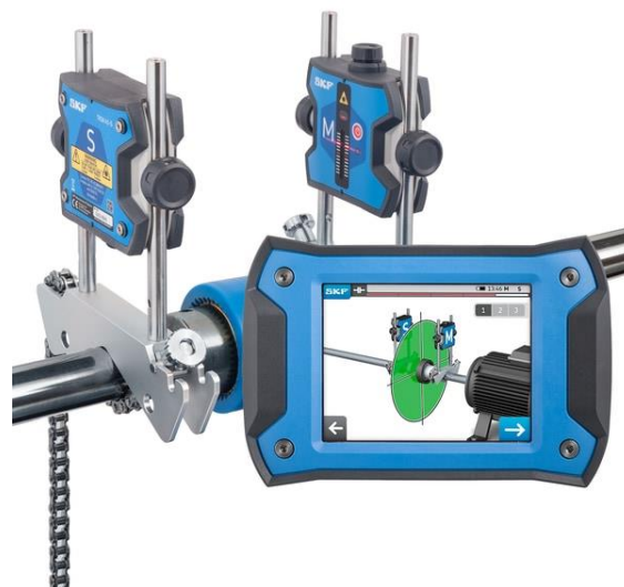
Ilustración 7-9.- Alineación mediante láser. Fuente: SKF
