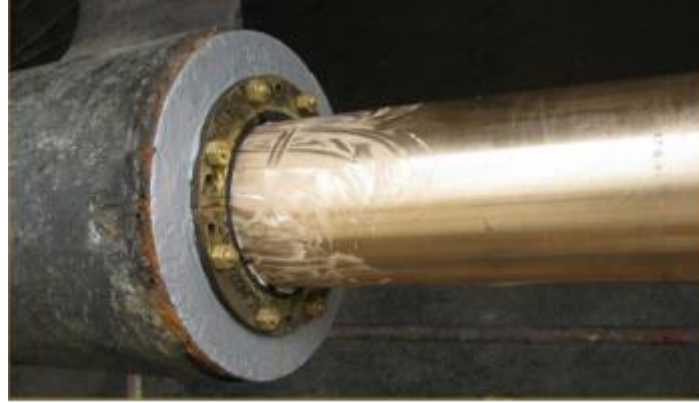
Ilustración 5-10.-Sello de bocina en el buque. Fuente: Johnson Cutless
