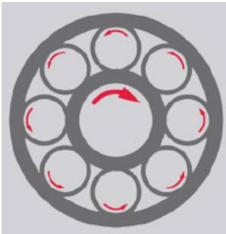
([23], S.F.) ILUSTRACIÓN 30 RODAMIENTO CON ANILLO EXTERIOR FIJO
