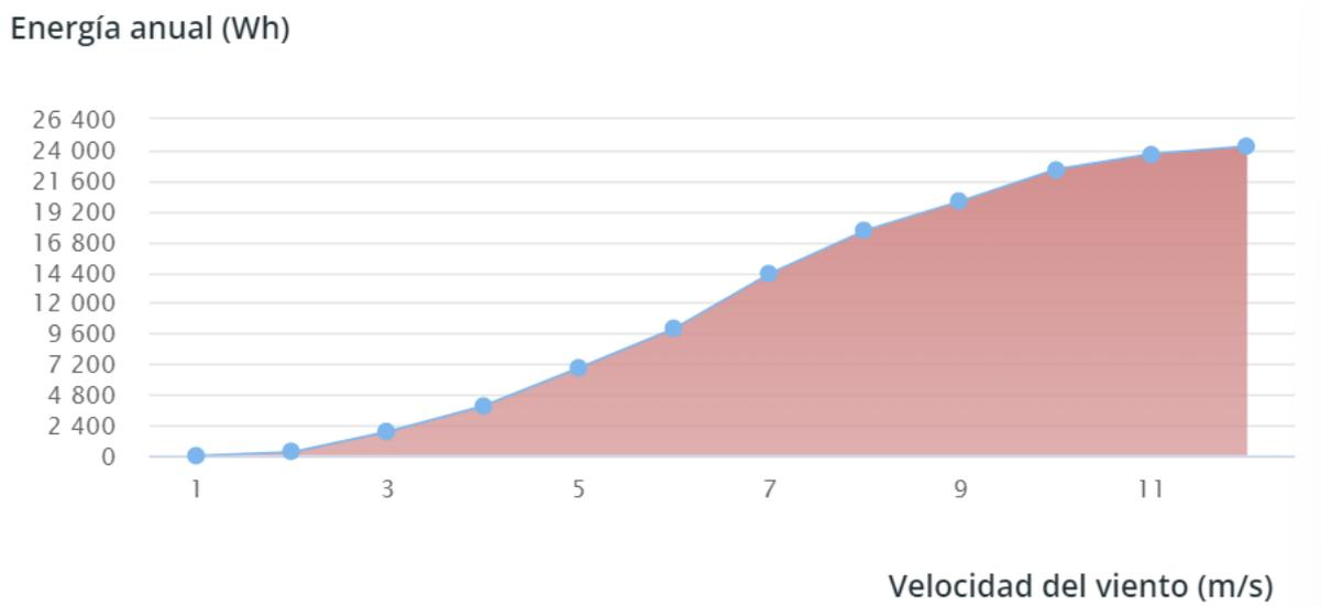
*Ilustración 15 - Producción anual aerogenerador 70 PRO, Enair*
