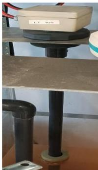
Ilustración 64 Sensor de flotador
