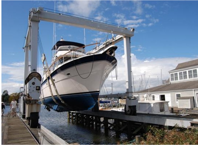
Ilustración 11. Buque saliendo del "pozo de elevación" mediante un travel lift
