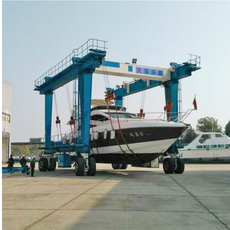
Ilustración 10. Travel Lift sobre ruedas transportando Yate
