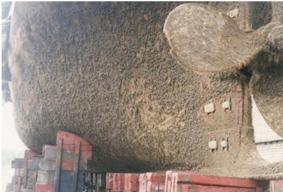
Ilustración 21. Casco de un buque con una gran capa de incrustaciones marinas
