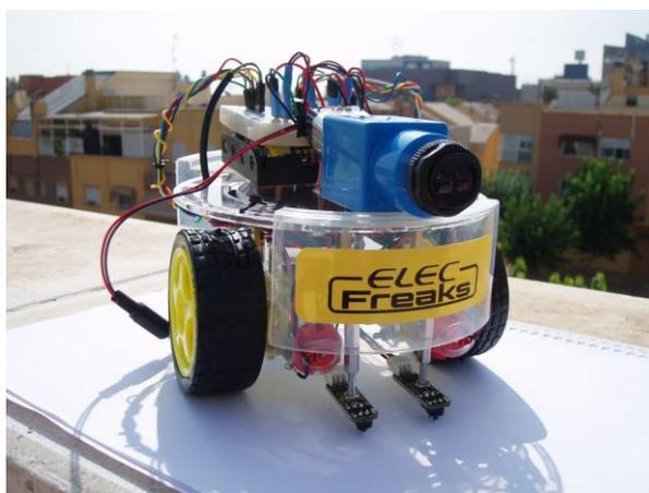
Figura.- Ejemplo de micro-robot seguidor de línea con detector de obstáculos.
