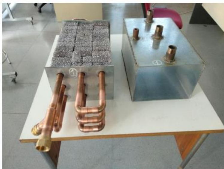
Fig. 12-Acumulador de espuma metálica en fase de montaje
