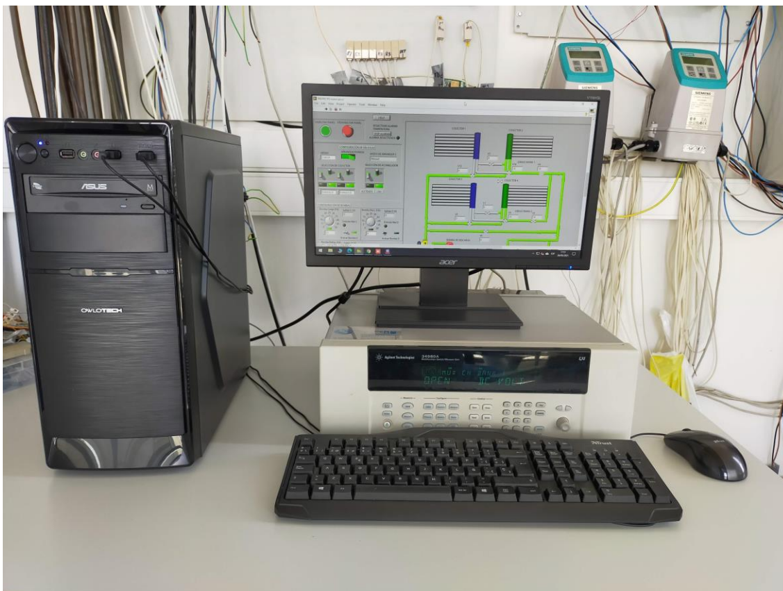
Fig. 11-Mesa de diseño con ordenador y adquisidor de datos, junto a PLC e instalación de control (variadores, relés, circuitos...)
